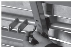
Fußseite des Bettrahmens. Das Verlegen des EPR-Netzkabels zur Kopfseite ist zu bevorzugen, da sich hier oftmals die Steckdose für eine Leselampe befindet.
