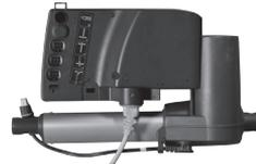
Die am Liegeflächenmotor angebrachte Steuereinheit ist mit einer erstfehlersicheren Elektronik ausgestattet. Dadurch werden unerwünschte Funktionsabläufe aufgrund eines ersten Bauteildefektes ausgeschlossen. Sie ist Spritzwasser geschützt nach IP x 4. Das Netzkabel entspricht EPR- Qualität (Etylen Propylen Rubber) und ist mit einem aufgeschobenen Knickschutz und einer Zugentlastung ausgestattet.
