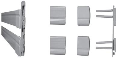
Die Holme des Seitengitters auf die Zapfen des Schiebers aufschieben.
