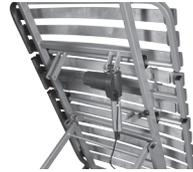
**Einbaurichtung** = Der Liegeflächenmotor wird mit dem Motorgehäuse in Richtung Kopfseite unter der Liegefläche befestigt (Aufkleber am Pflegebett beachten) Liegeflächenmotor zwischen den Aufnahmen an der Liegefläche einpassen und Schnellverschlussbolzen einsetzen und durch schließen des Sicherungsbügels sichern.
